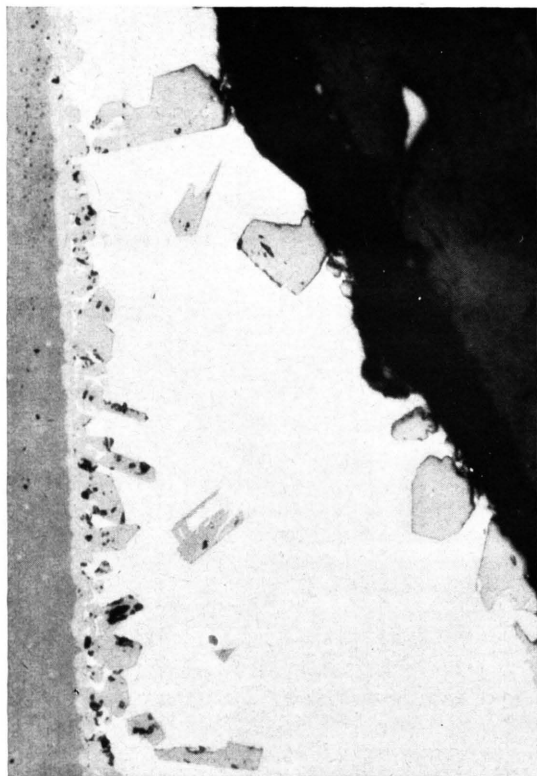
Abb. 4. Grenzsicht aus Siliciumcarbid zwischen Glaskohle (links) und Silicium-Schmelze und beim Abkühlen ausgefallene SiC-Kristalle in 200-facher Vergrößerung.
